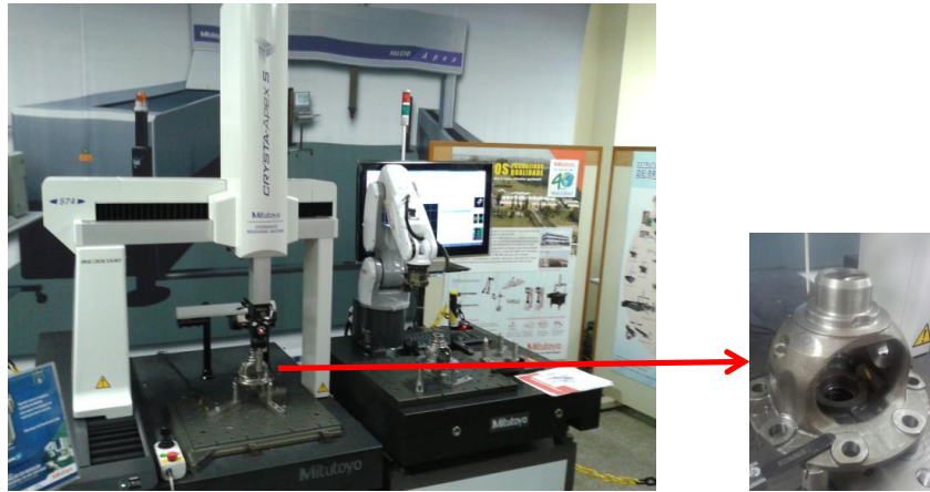
Figura 9 - Máquina de medir integrada a robô em ambiente sem controle de temperatura
