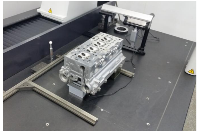
Figura 11 - Infraestrutura laboratorial empregada para compensação de calor residual da peça
