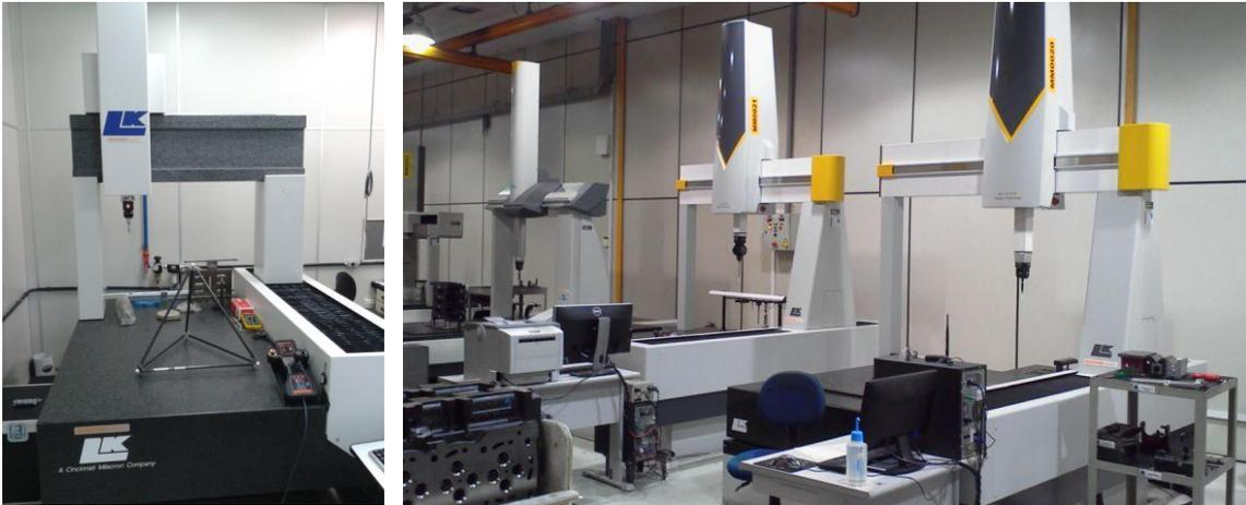
Figura 8 - Máquinas de Medir por Coordenadas avaliadas
