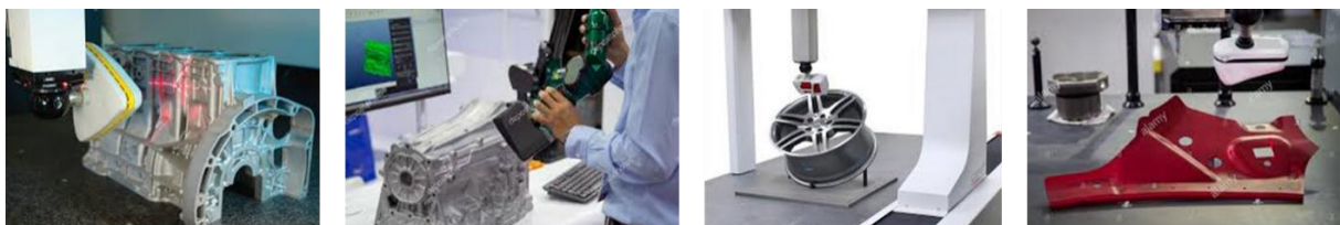
Figura 3 – Exemplos de aplicação da medição por coordenadas com apalpação por triangulação laser
